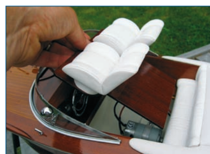
La platine avant reçoit les sièges du pilote et de son passager. Cette platine constitue la trappe qui permet l'accès au moteur et à l'accouplement à l'arbre d'hélice. Elle est maintenue en place par gravité. Nous avons ajouté un système de verrouillage identique à celui de la trappe arrière, en corde à piano.
