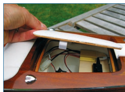
La platine qui abrite les éléments de la radio embarquée. Notez les matelas du bain de soleil, réalisés en simili cuir. Le verrouillage est obtenu via les deux pattes en plastique implantées au verso de la platine. Simple et efficace.
