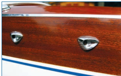
La ligne d'échappement bâbord.
